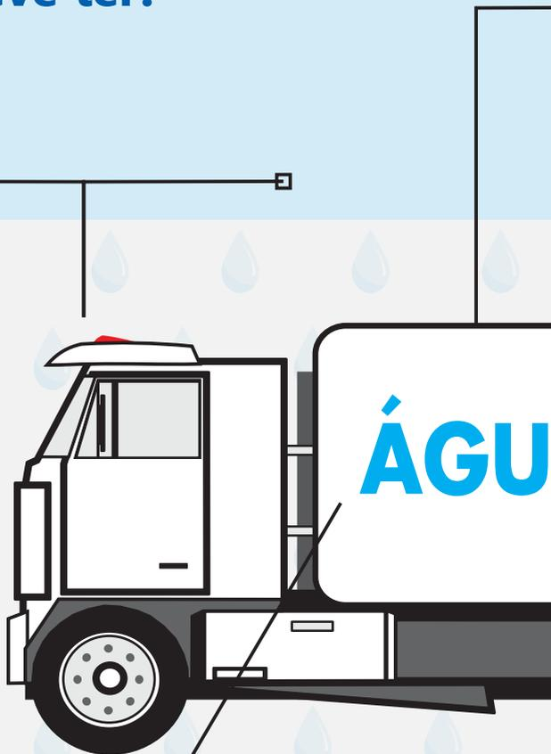
A parte interna do tanque deve ser lisa e impermeável (não absorver água), construída ou revestida de material anticorrosivo e antioxidante, não tóxico, que não altere a qualidade da água e que proteja o interior da ação dos produtos químicos usados na desinfecção de rotina.
